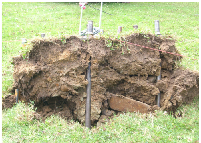
Bild 6: Erdanker mit 12 gegen die Belastungsrichtung geneigten Erdnägeln in Ton kurz vor dem Tragfähigkeitsverlust (links) und danach (rechts).
