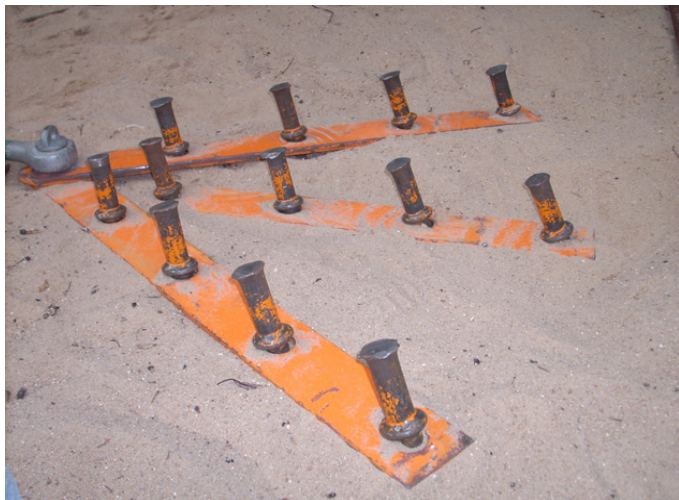
Bild 2: Erdanker mit 12 in Belastungsrichtung geneigten Erdnägeln in Sand bei Versuchsbeginn .
