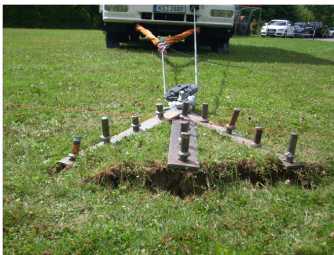
Bild 6: Erdanker mit 12 gegen die Belastungsrichtung geneigten Erdnägeln in Ton kurz vor dem Tragfähigkeitsverlust (links) und danach (rechts).
