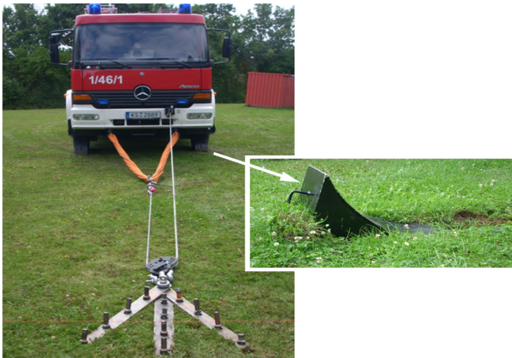
Bild 5: Versuchsanordnung bei Erdankern mit 12 Erdnägeln (links) und bei Versuchsdurchführung verschobenem Unterlegkeil (rechts).
