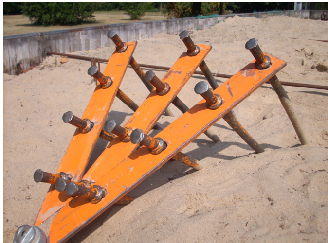
Bild 3: Erdanker mit 12 in Belastungsrichtung geneigten Erdnägeln in Sand bei Versuchsende .
